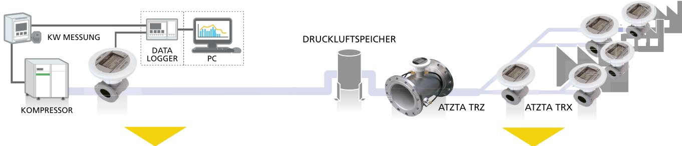
Bestimmung der spezifischen Verdichterleistung. Die Kontrolle des Stromverbrauchs pro m<sup>3</sup> trägt zum effektiveren Betrieb des Kompressors und zur Reduzierung der Stromkosten bei.
